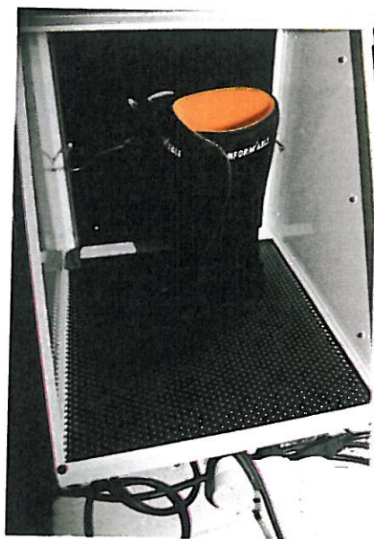
▲ Un chausson thermoformable dans le four du magasin Le Yéti à Montpellier. Une fois chauffé à environ 100°C, on enfle le chausson ramolli et on l'insère dans la coque. Laissez refroidir un quart d'heure, et le chausson sera parfaitement moulé au pied et à la coque des chaussures !
